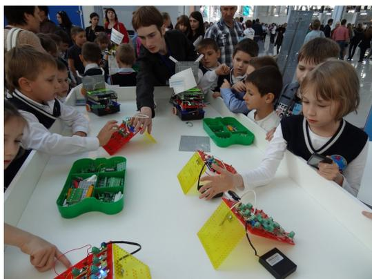
Конструктор содержит большой базовый набор электронных элементов и модулей. Модули для изучения российских микросхем входят уже в базовую версию. Также в набор входит мультиклеточный процессор.
