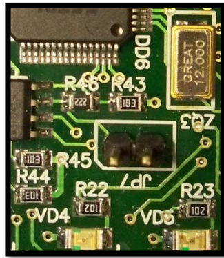
Рис. 8. Джампер JP7 отсутствует
