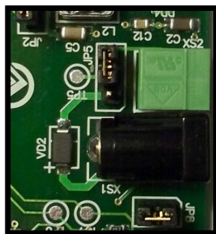
Рис 7. Положение джампера JP5
